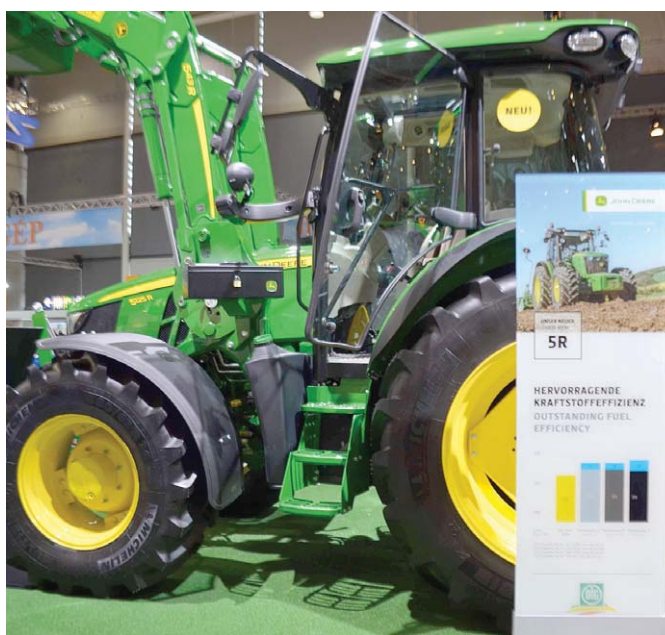
Rezultati ispitivanja potrošnje goriva za 5R seriju traktora govore o 265 g/kWh
