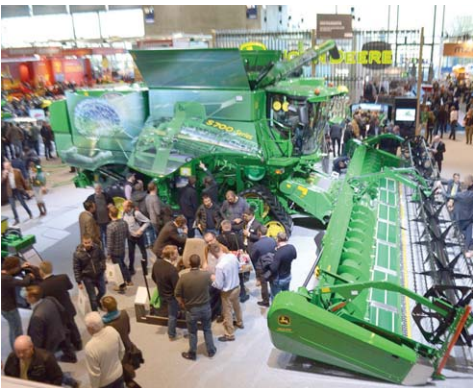
Uz kombajn S700, John Deere također uvodi i novu 700PF seriju Premium Flow hedera s širinom kose od 6,7 do 9,1 m
